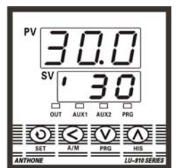
下显示窗内容设置为 Dis=p 时的显示状态
